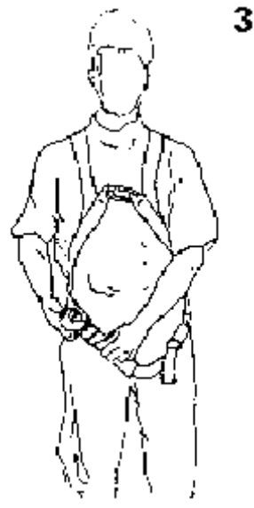
FIGURA 3: regolare la tensione dei nastri cosciali, tirando o rilasciando l'estremità libera del nastro. Fare attenzione a posizionare bene la placca dorsale a livello delle scapole.
