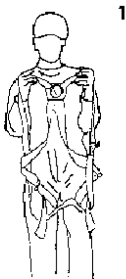
FIGURA 1: controllare che le cinghie non siano arrotolate
