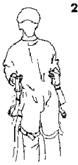
FIGURA 2: infilare l'imbracatura avendo cura di non attorcigliare il nastro ed assicurarsi di avere la placca arancione sulla schiena
