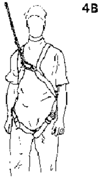
FIGURA 4A E 4B: L'agganciamento del sistema d'arresto di caduta all'imbracatura deve essere effettuato esclusivamente all' anello dorsale sulla placca arancione (4 A) oppure alle due asole sternali in nylon (4B)
